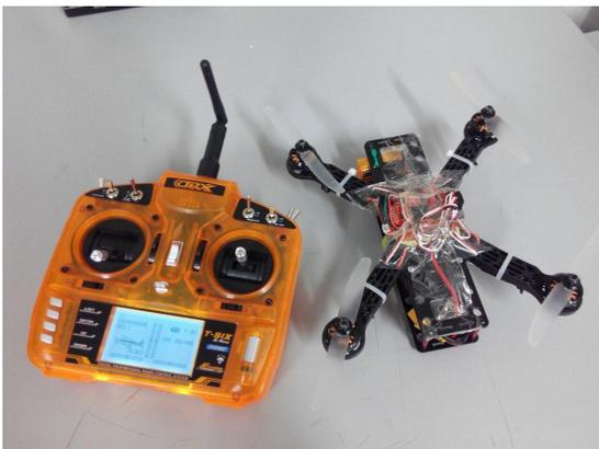
Durante el curso 2014-15 realizamos desde el Club de Robótica el proceso de diseño, compra de materiales, y montaje de un cuadricóptero. Éste tipo de robots son capaces de volar gracias a cuatro hélices actuadas por motores de alta velocidad.
