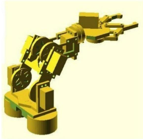
*Brazo mecánico diseñado en OpenScad*
