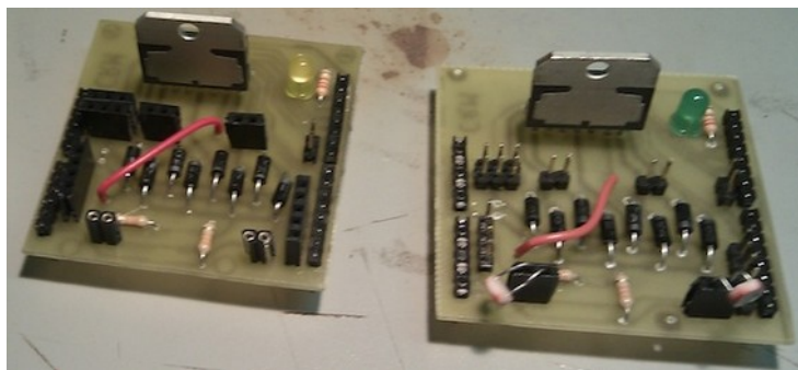
Diseño del PCB con Kicad y posterior fabricación para su uso en el taller
