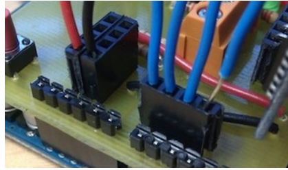
Conexión directa mediante zócalo hembra en placa y cable unifilar
