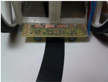
Nuestro robot tiene una tira de 4 sensores separados más o menos 0.5 cm, así que podemos detectar la posición de la línea con una precisión de medio centímetro.
